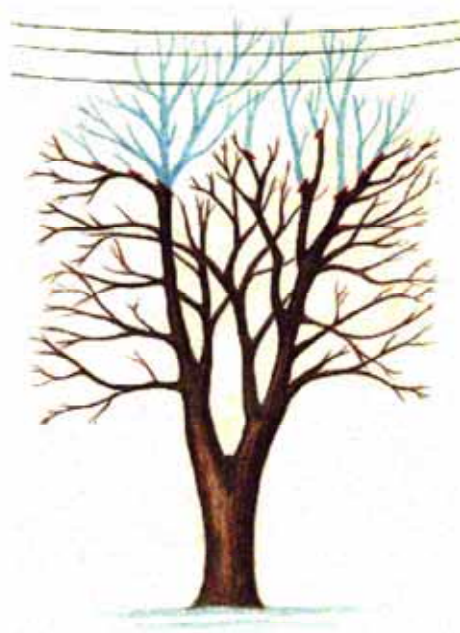
Fig. 5: Riduzione della chioma mediante taglio di ritorno in presenza di linee elettriche.
